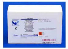
カリウム用のリフレクトクアントには試験紙タイプもあるが、塩素により測定が妨害されるため、塩酸抽出した試料では測定できない。そのため、RQ フレックスプラスで液の濁度からカリウムの濃度を測定するリフレクトクアントプラス カリウムテスト (1.0 - 25.0mg/l) を使用する。
