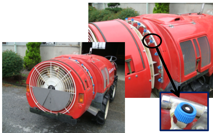
風量調節板(左下)と飛散低減ノズル(右上)
